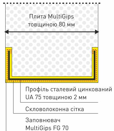
При вертикальному укладанні плит останнього ряду, над дверним отвором слід розмістити плити довшою стороною, а потім приклейти зверху вставки відповідної ширини.
