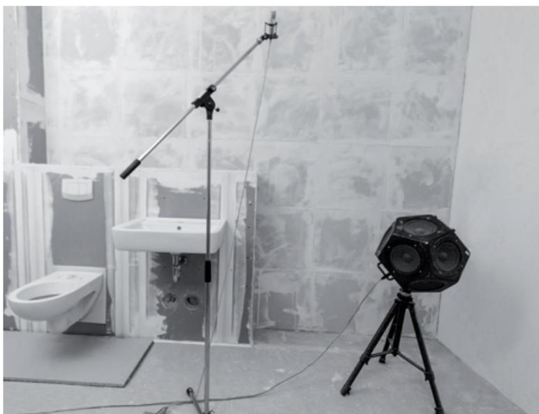
Dies ist für die diagonale Übertragung in einen fremden Wohnbereich von Bedeutung, denn für die baurechtlich verbindlichen Anforderungen der DIN 4109 ist die diagonale Übertragung in benachbarte fremde Wohnbereiche zu berücksichtigen.
