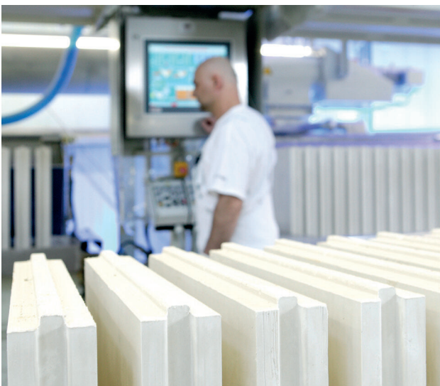
Abb. 18: Produktionsbedingt hochglatte Sichtflächen für oberflächenfertige Wände
