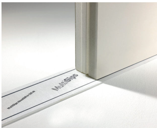
Abb. 7: Gips-Wandbauplatte mit Randanschlussstreifen aus PE-Schwerschaum als bauliche Einheit
