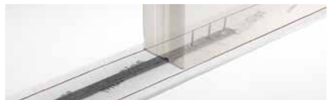
Abb. 16: Sachgemäß armierte Öffnung als vorbeugender Schutz gegen ungewollte Belastungen
