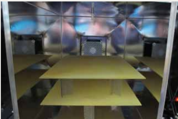
Prüfkörper erstellt: MultiGips Betonkontakt Spray, orange pigmentiert, auf satinierte Glasplatten. Bildnachweis: © Fraunhofer IBP
