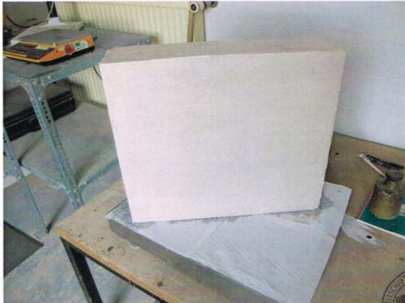
Bild 4: Grundierung mit Tiefgrund.
