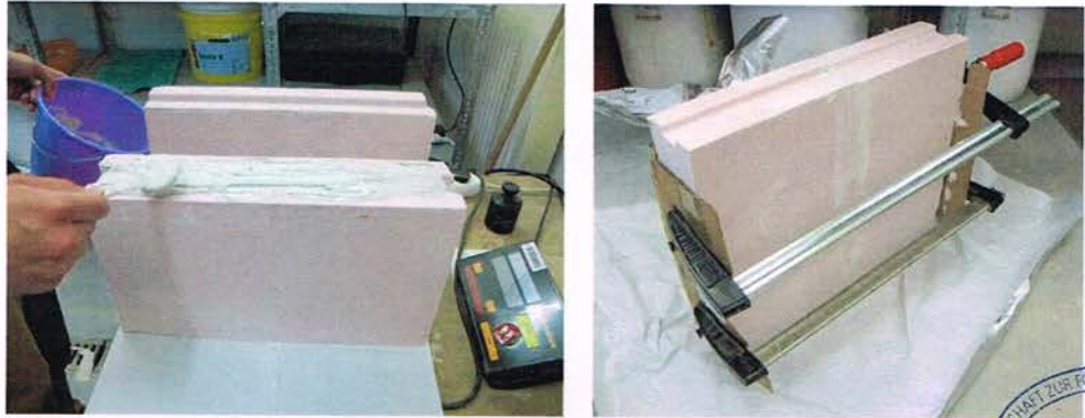
Bild 2: Verkleben der zugeschnitten Gipswandbauplatte.
