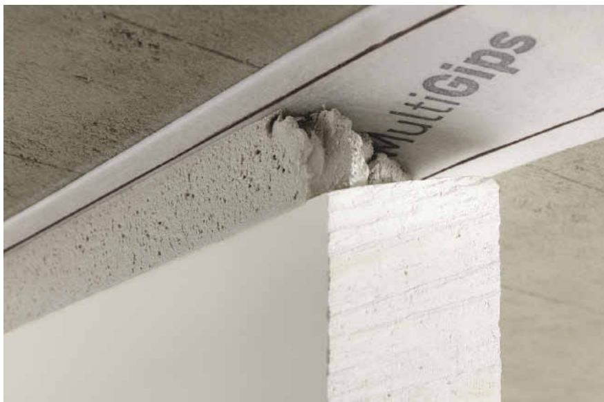
Elastisch angeschlossen, akustisch entkoppelt: Weiterleitung von Körperschall wird reduziert, die Flankendämmung der Wand erhöht.
