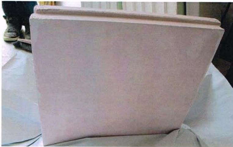
a) MultiGips D100 Rmax Schallschutzplatte.
