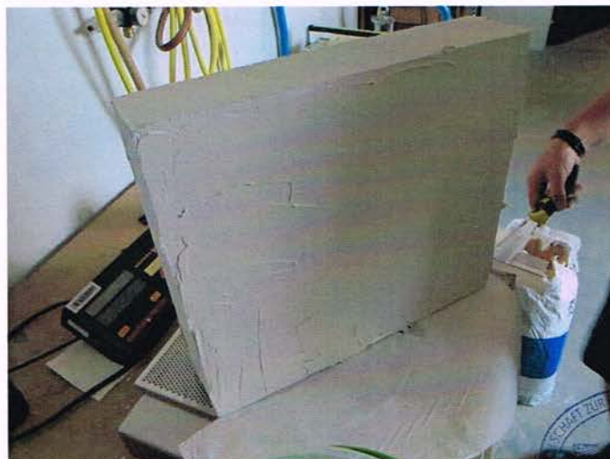
Bild 3: Verspachteln der Gipswandbauplatte.
