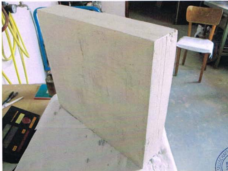
Bild 4: Grundierung mit Tiefgrund.
