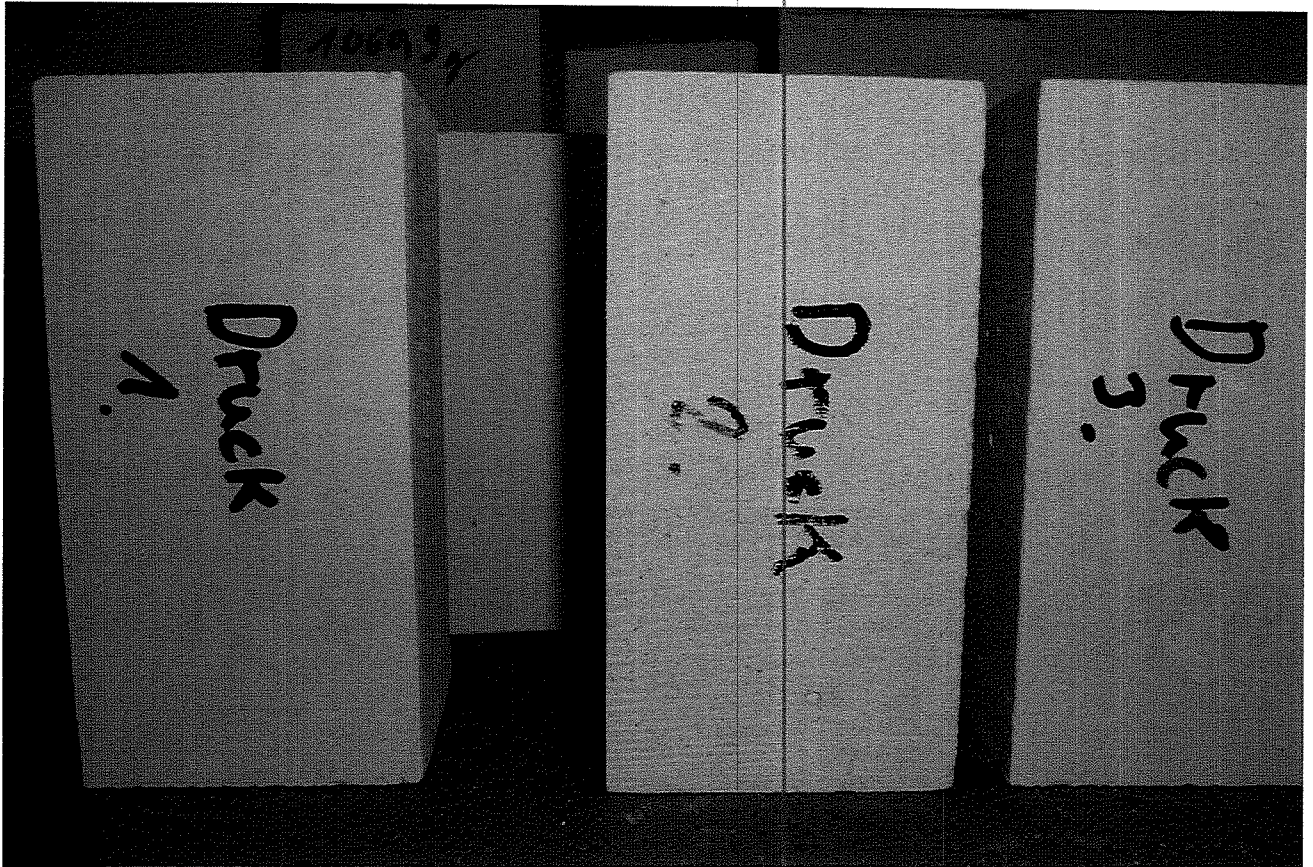
Bild A.7: Ansicht drei Gipsprismen zur Überprüfung der Druckfestigkeit der Proben.
