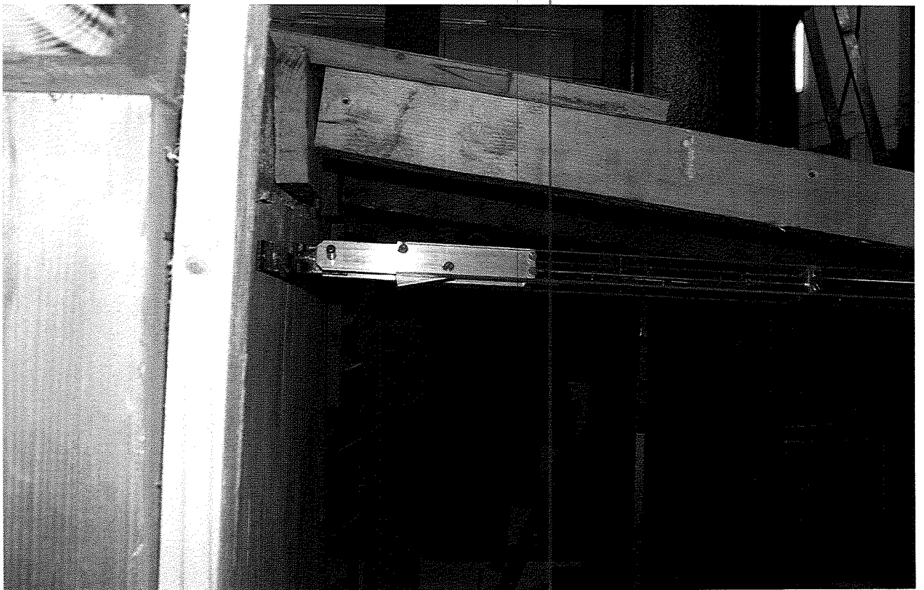
Bild A.2.2: Versuchsaufbau. Ansicht auf den Wegaufnehmer am Wandkopf. Es befinden sich zwei Wegaufnehmer am Wandkopf.
