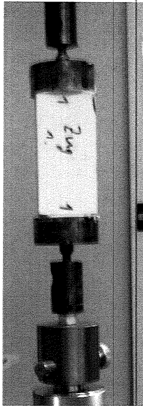
Bild A.8.1: Gips-Zugprobe in der Prüfmaschine.
