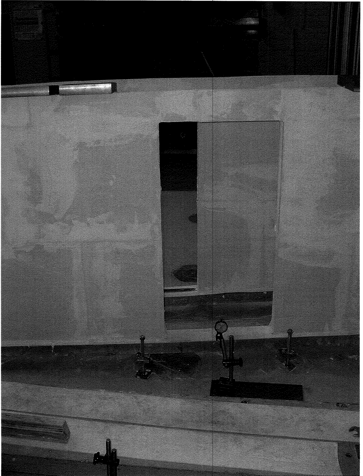
Bild A.12: Wand 2.2 mit Lastplatten. Messuhr in Feldmitte nimmt die Verformungen auf. Türsturz (12,5 cm hoch) im Maßstab 1:4.
