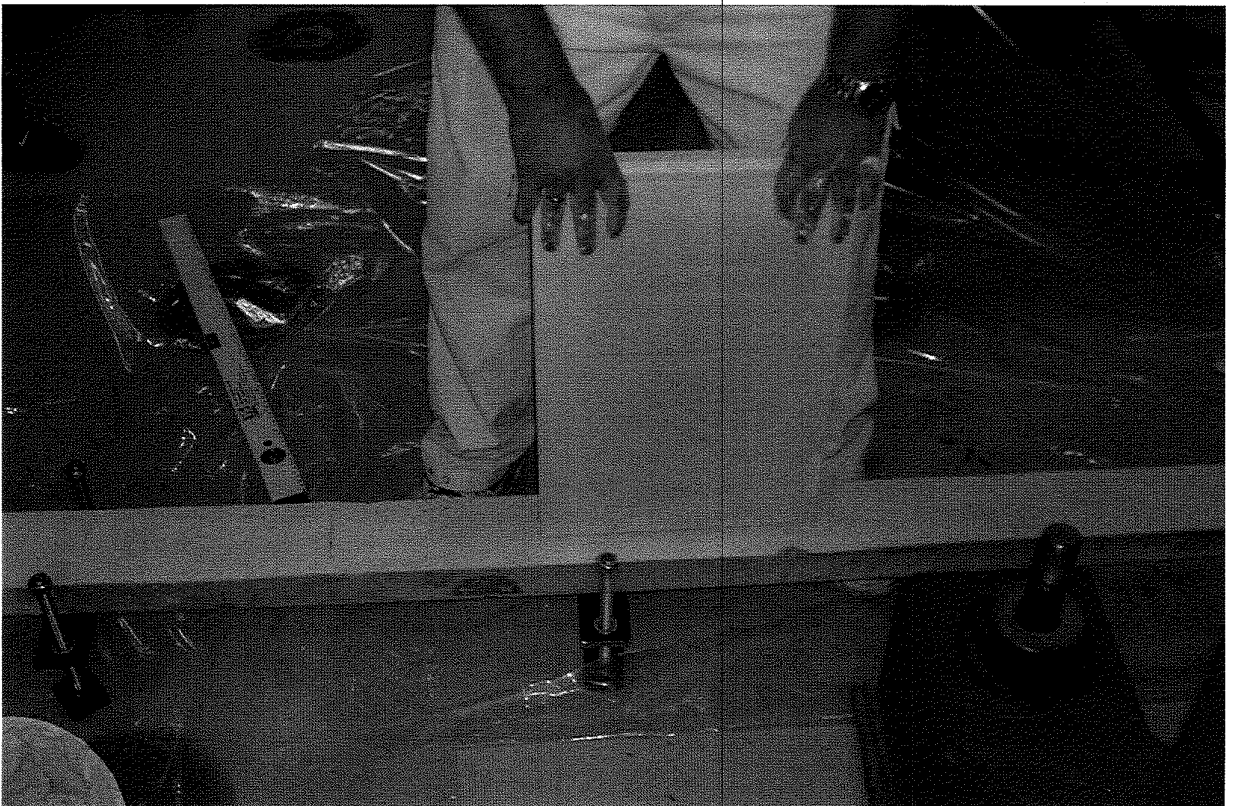
Bild A.3.2: Aufsetzen der ersten Platte trocken auf den PE-Schwerschaum.
