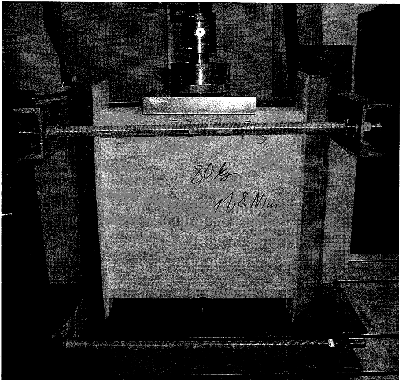
Bild A.14: Probekörper mit PE-Schwerschaum (Rohdichte von \rho \geq 80 \text{ kg/m}^3 ), Pressung von 0,085 \text{ N/mm}^2 .
