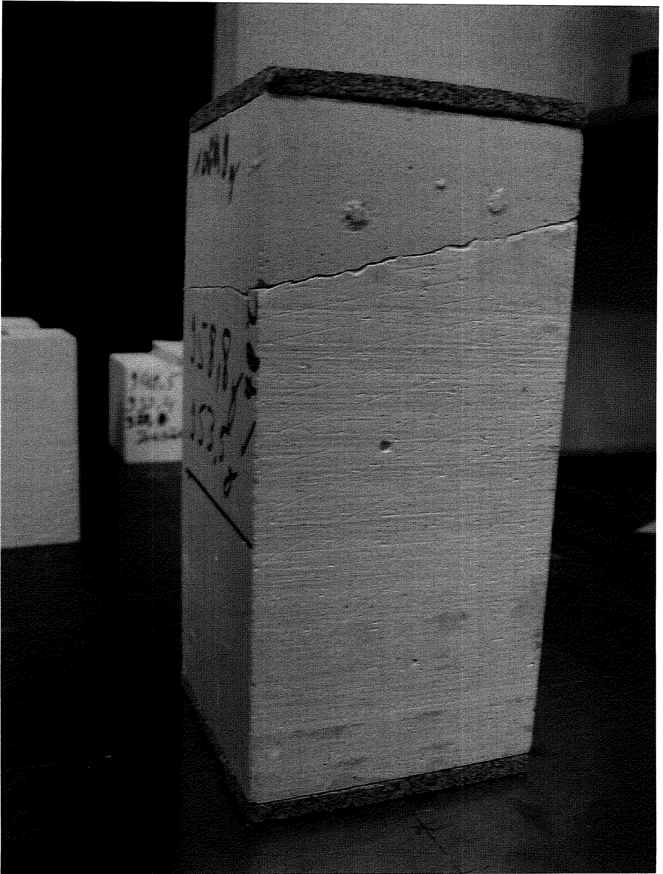
Bild A.24: Probekörper mit Korkstreifen ( \rho \geq 300 \text{ kg/m}^3 ), Gipsprisma verfüllt, und Korkstreifen.
