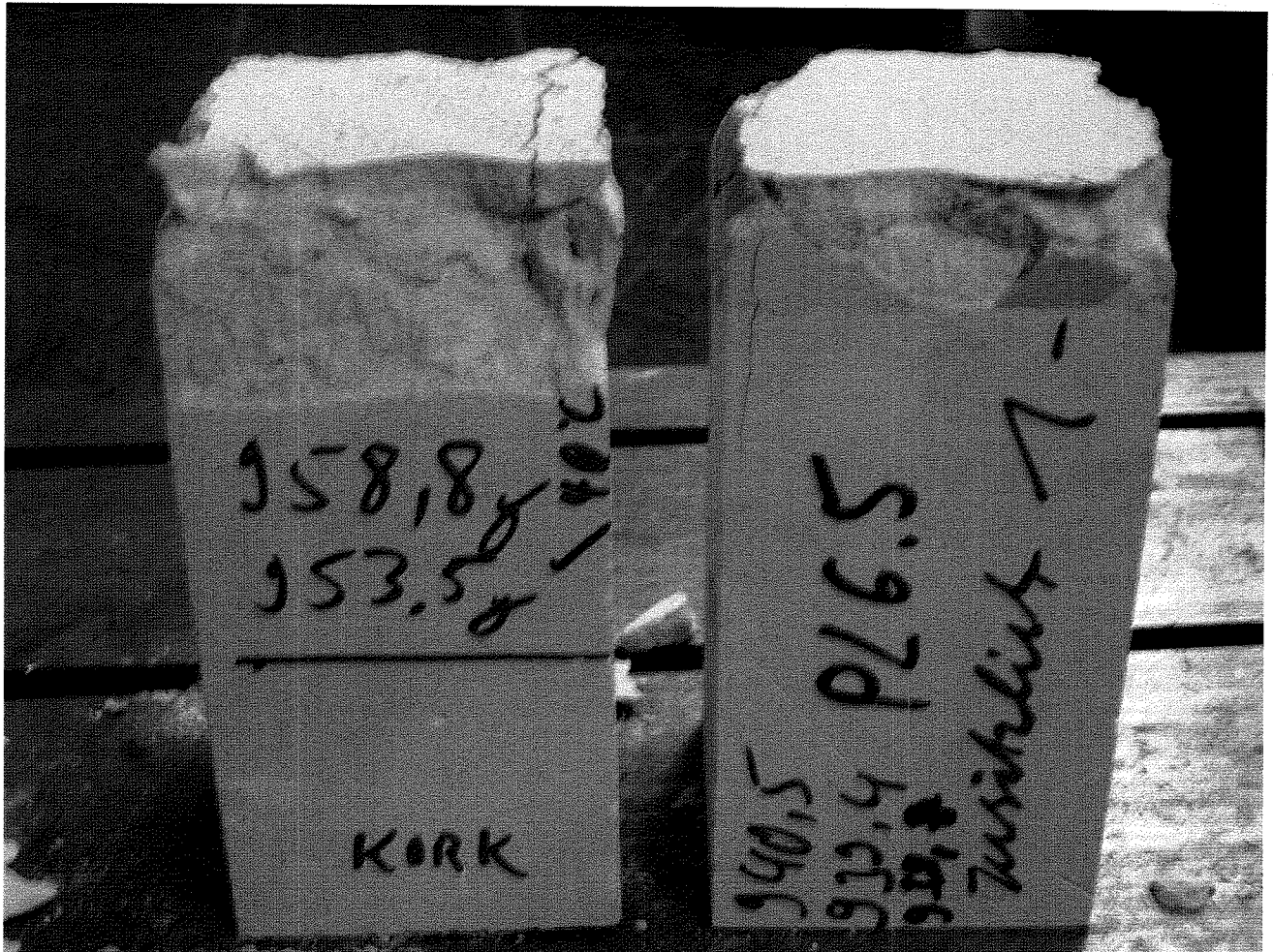
Bild A.28: Probekörper mit nach dem Versuch an Gesamtsystem PE-Streifen ( \rho \geq 120 \text{ kg/m}^3 ), Gipsprisma verfüllt, und PE-Streifen und Korkstreifen ( \rho \geq 300 \text{ kg/m}^3 ), Gipsprisma verfüllt, und Korkstreifen. Beide Gipsprismen haben im Bereich der Verfüllung versagt.
