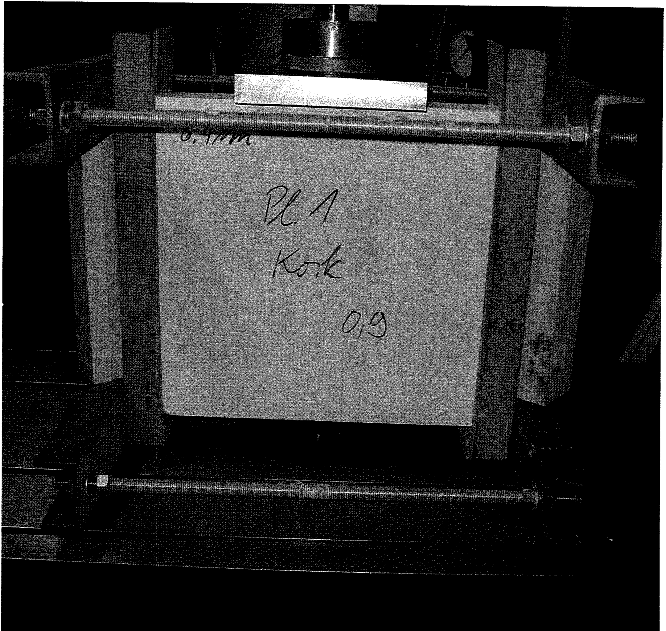
Bild A.17: Probekörper mit Korkstreifen ( \rho \geq 300 \text{ kg/m}^3 ), Pressung von 0,085 \text{ N/mm}^2 . Einbau in Prüfmaschine. Mittige Belastung über eine Lastplatte.
