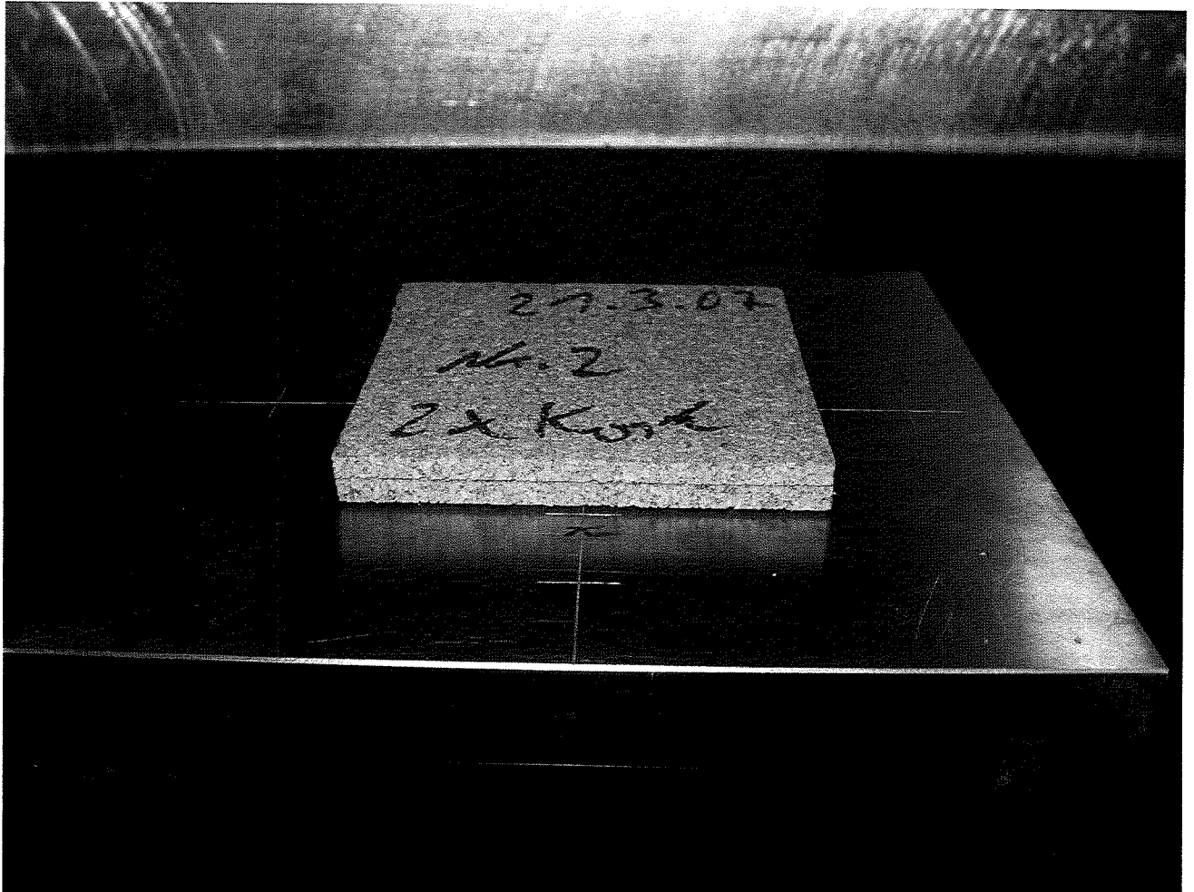
Bild A.4: Aufsicht in die Prüfmaschine für die Kraft-Verformungsmessung für Kork ( \rho \geq 300 \text{ kg/m}^3 ) allein.
