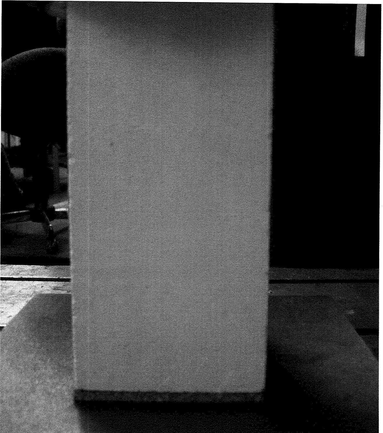
Bild A.10: Aufsicht in die Prüfmaschine für die Kraft-Verformungsmessung für Korkstreifen ( \rho \geq 300 \text{ kg/m}^3 ) Gips-Probekörper und Korkstreifen.
