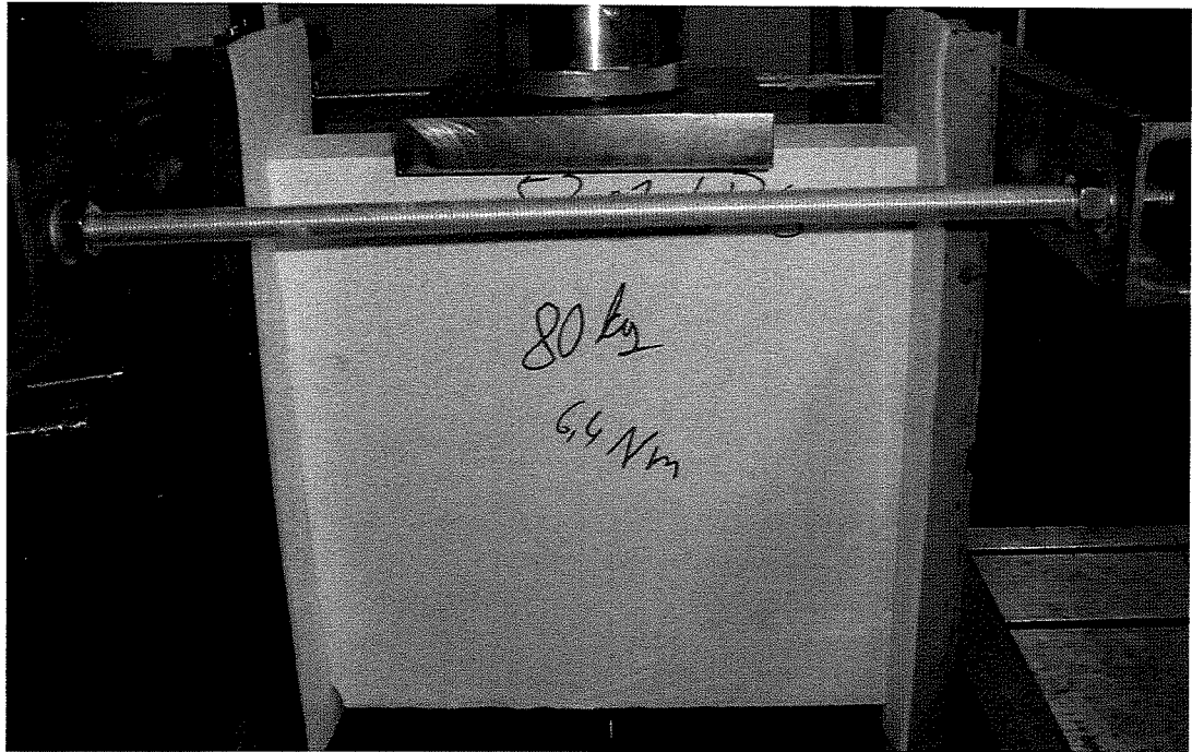
Bild 6: Ansicht des Versuchsaufbaus mit PE-Streifen (Rohdichte \rho \geq 80 \text{ kg/m}^3 ).
